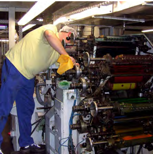
Sechsfarbandruckwerk an einer Tubenlinie
